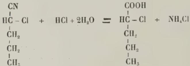
Dans un ballon muni d'un long tube servant de réfrigérant, la cyanhydrine chlorée est traitée par environ deux fois son volume d' $\text{HCl}$  concentré, et l'on chauffe au bain d'eau. Le nitrile valérique  $\alpha$  chloré est assez soluble dans l' $\text{HCl}$  concentré, de sorte que l'hydratation se fait assez rapidement, et au bout de trois heures de chauffe, on constate après refroidissement un dépôt abondant
